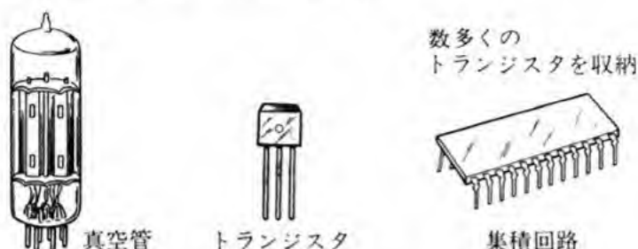
図2 真空管・トランジスタ・集積回路
